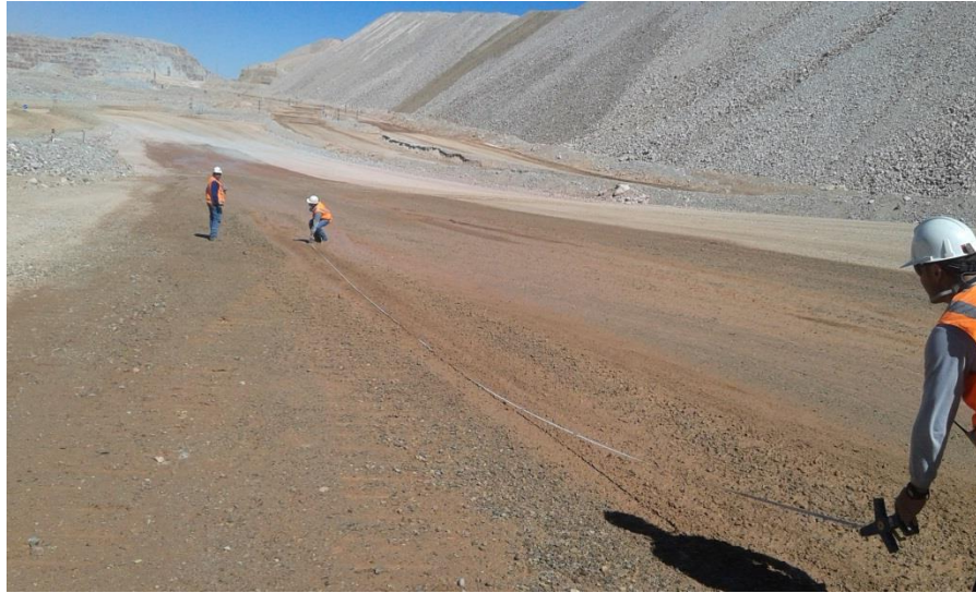
FOTO 3.-MEDICION HUELLAS DE FRENADO MEL
